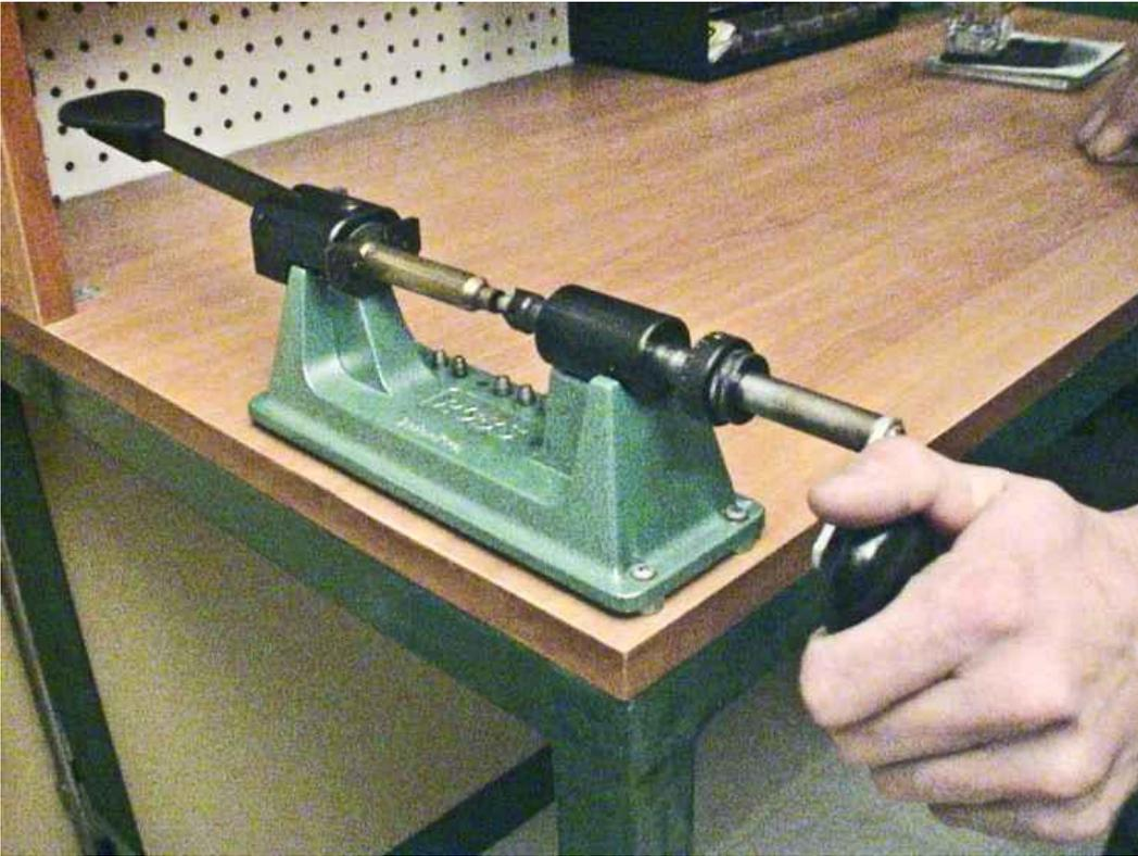
Un raccourcisseur de douille (Case Trimmer) est essentiel pour ramener les douilles à leur longueur nominale et s'assurer que leur embouchure soit parfaitement droite. À une extrémité, cet outil comporte un socle de retenue de la douille, à l'autre extrémité une tige à manivelle à tête tranchante. Coût approximatif : 125 \$.
