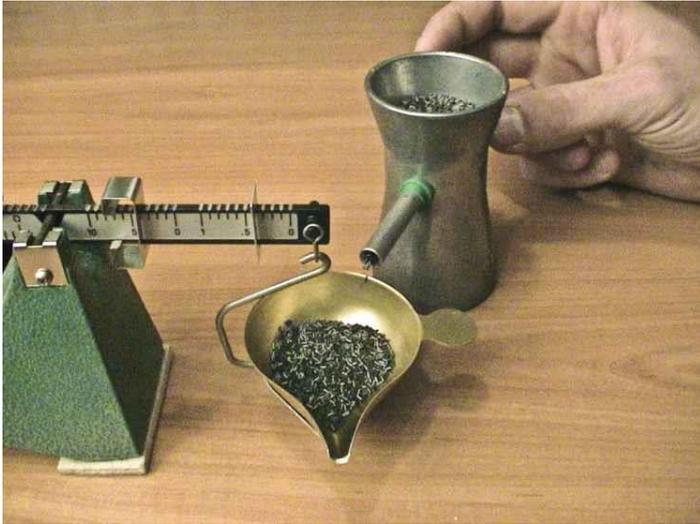
Un distributeur grain à grain (Powder Trickler) est un petit réservoir de poudre muni d'un tube-déversoir rotatif qui laisse tomber la poudre grain à grain. Cet accessoire permet de compléter précisément et rapidement la charge voulue sur le plateau de la balance. Sans cet accessoire, il est beaucoup plus laborieux de finaliser la pesée exacte de la charge de poudre. Coût approximatif : 25 €.
