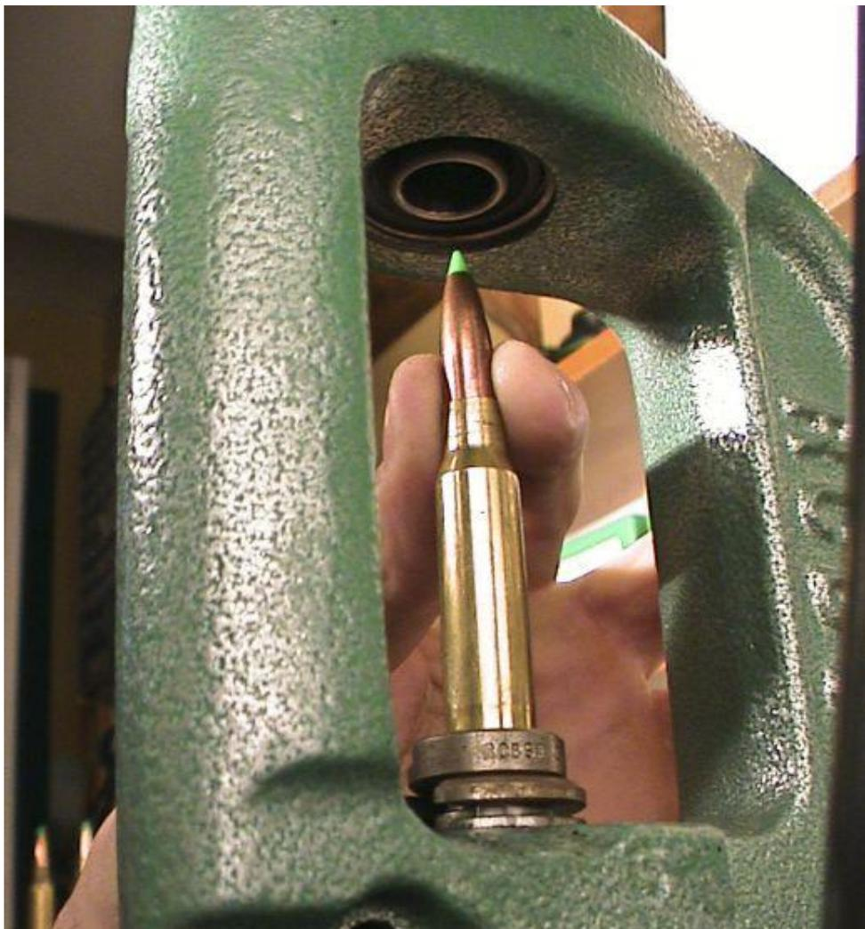
Continuez alors doucement l'abaissement du levier pour compléter la montée du pilon et l'assise de la balle dans le col de la douille. Au rabaissement du pilon, il ne vous reste plus qu'à retirer du porte-douilles votre cartouche rechargée.
