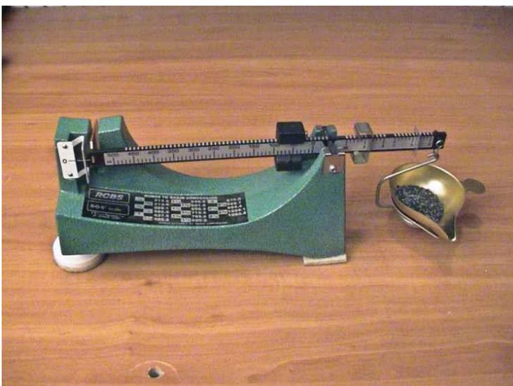
*Instrument à balancier pour mesurer les charges de poudre*
