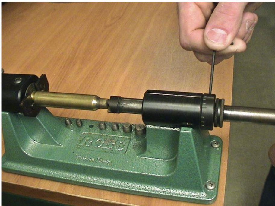
Commencez par un premier essai de coupe légère, vérifiez la longueur au Vernier et procédez à l'ajustement fin de l'outil pour obtenir la longueur désirée sur une première douille, puis passez toutes les autres douilles de la même façon dans l'outil. Remplacez les douilles coupées dans votre deuxième plateau, encore une fois pour départager les unes des autres.
