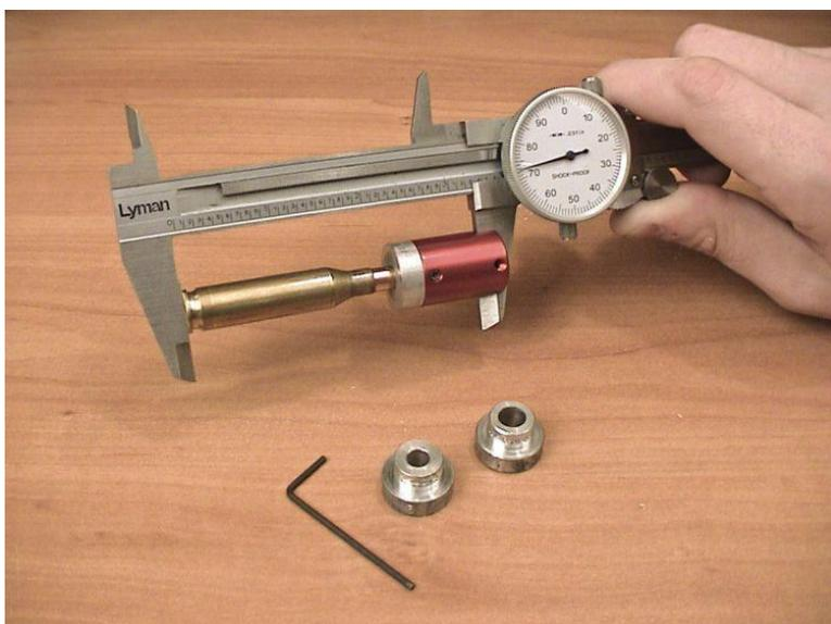
Si la précision maximale vous intéresse, vous devriez vous procurer un outil de jauge spécial permettant de mesurer précisément, à l'aide d'un Vernier, la longueur d'une cartouche de la base du culot jusqu'au début de l'ogive. Cette mesure à l'ogive est en effet plus constante et plus importante que celle de longueur totale à la pointe, cette dernière pouvant souffrir de quelques inexactitudes de fabrication.
