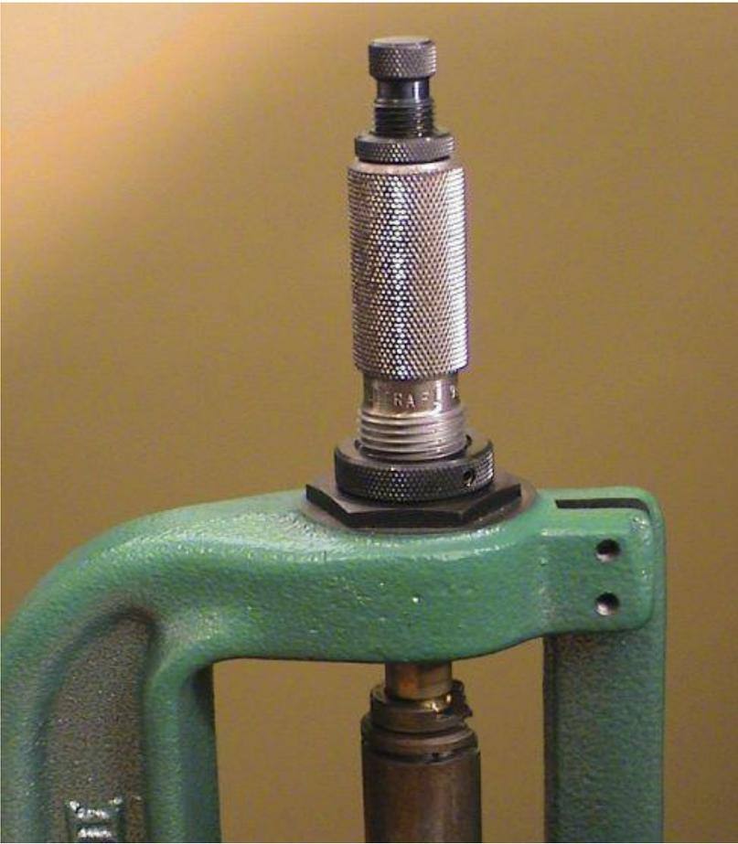
Vous devriez sentir une friction modérée lors des opérations de décapsulage de la vieille amorce par la tige et de resserrement des parois de la douille dans la matrice de recalibrage, et finalement d'expansion du col par le bouton lors de la sortie de la douille. Si vous sentez une tension induite lors de l'entrée ou de la sortie de la douille de la matrice, la lubrification n'est probablement pas suffisante.
