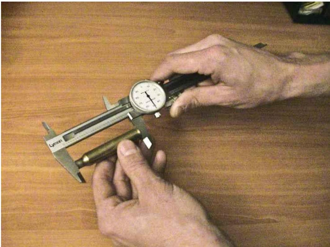
Le Vernier (Dial Caliper) est un autre outil essentiel pour mesurer précisément la longueur des douilles, ainsi que celle des cartouches complétées, et s'assurer ainsi qu'elles demeurent dans les dimensions recommandées. Coût approximatif : 75 \$.
