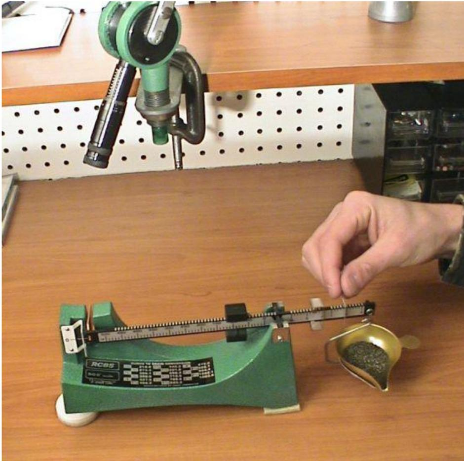
À ce stade, avant de déverser la poudre dans une douille, on devrait effectuer cinq autres essais consécutifs de déversement et de pesée de charge pour s'assurer de la constance de la mesure. Les adeptes de précision ultime préfèrent souvent peser précisément chaque charge, même si une bonne mesure peut donner une constance satisfaisante avec des poudres à grain fin.
