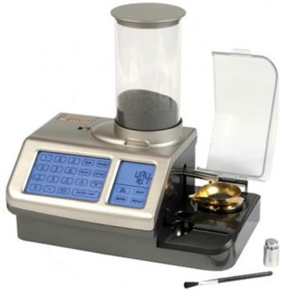
Beaucoup plus évolué au niveau automatisme (pas en précision) les systèmes automatiques de dosage proposés par divers constructeurs combinent une balance électronique de précision, une doseuse et égreneuse électronique.
