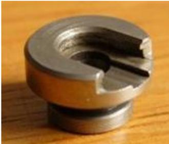
Un support de douille (Shell Holder) sera possiblement fourni avec votre presse, mais cet item est aussi disponible séparément. Un seul support peut convenir à plusieurs douilles de calibres différents, en autant que les dimensions de base de la jante, de la rainure d'extraction et de l'orifice d'amorce soient similaires. Coût approximatif : 10 €.
